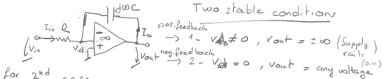
$$\begin{cases} I_{in} = V_{in}/R \\ I_o = -I_{in} \\ V_{out} = \frac{I_o}{jwC} \end{cases}$$
