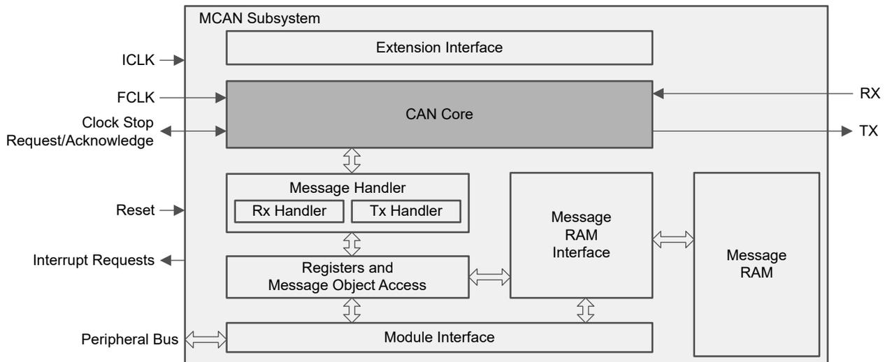
**Figure 19-3. MCAN Block Diagram**
