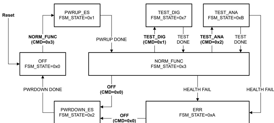
**Figure 22-2. TRNG State Flow**
