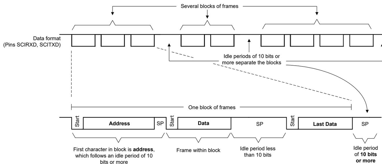
**Figure 16-9. Idle-Line Multiprocessor**
