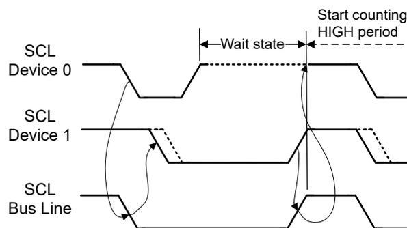
**Figure 18-9. Clock Synchronization**
