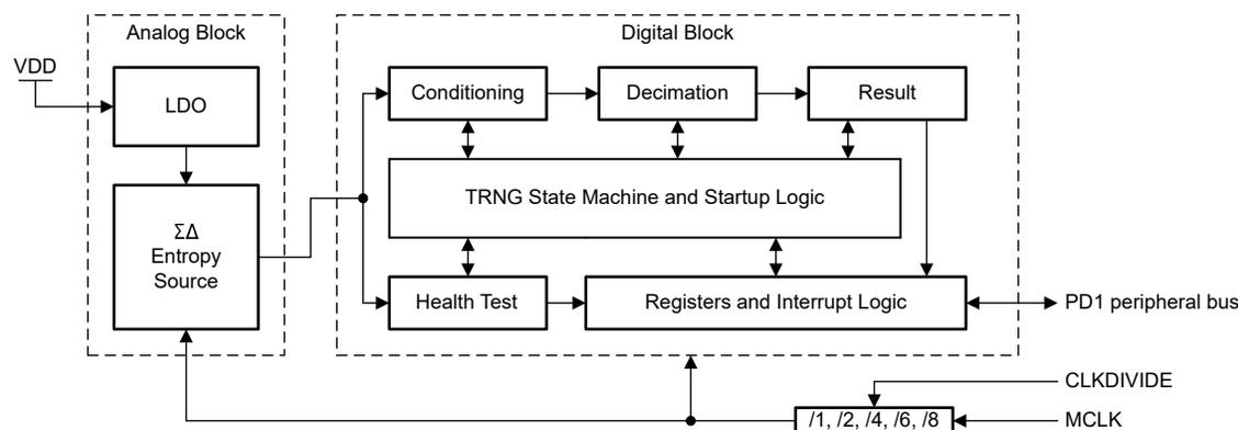
**Figure 22-1. TRNG Block Diagram**
