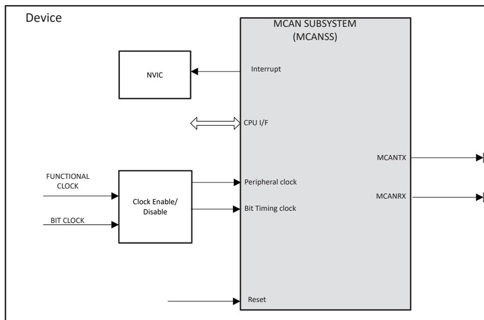
**Figure 19-1. MCAN Block Diagram**
