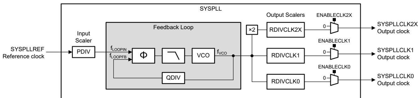
Figure 2-7. SYSPLL Diagram
